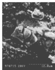
图3 贮氢合金扫描电镜照片 Fig. 3 SEM photo of HAA
