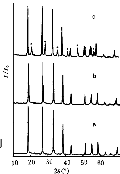
图 2 \text{Li}_{2+x}\text{Gd}_x\text{Si}_{1+x}\text{O}_3 样品的 XRD 谱图
