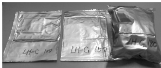
图4 铝塑包装单一正极经不同温度热处理后的照片
