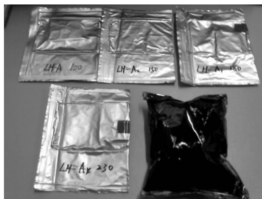
图 7 铝塑包装单一负极不同温度热处理的照片
