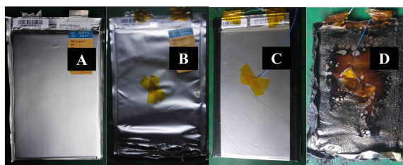
图 7 电池的挤压测试
