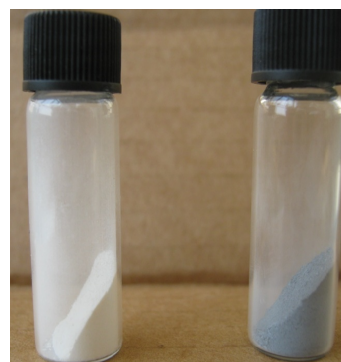
图 1 TiO 2 (白色) 和氢处理 TiO 2 (灰黑色) 样品照片
